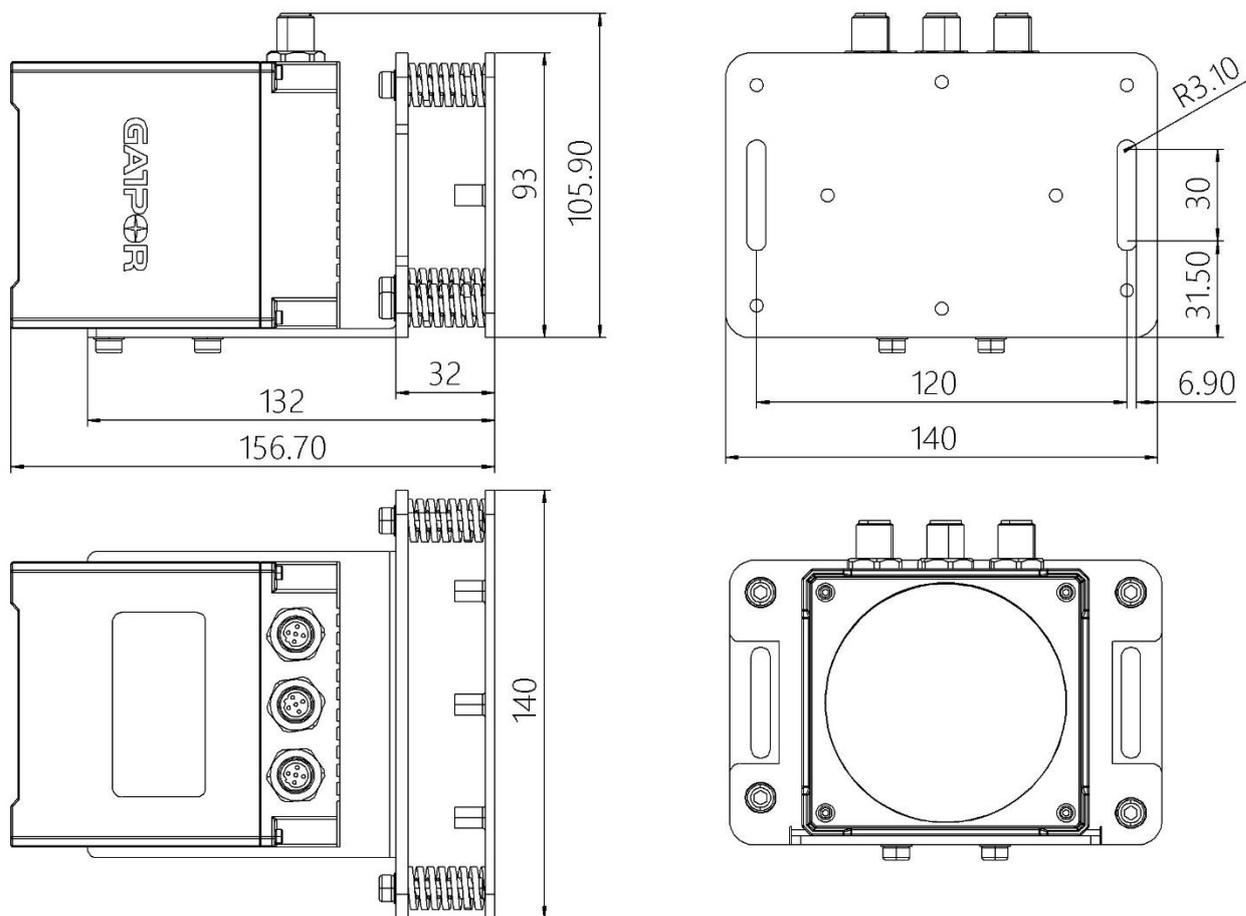
图 3.2: 支架组装尺寸图 (单位: mm)
