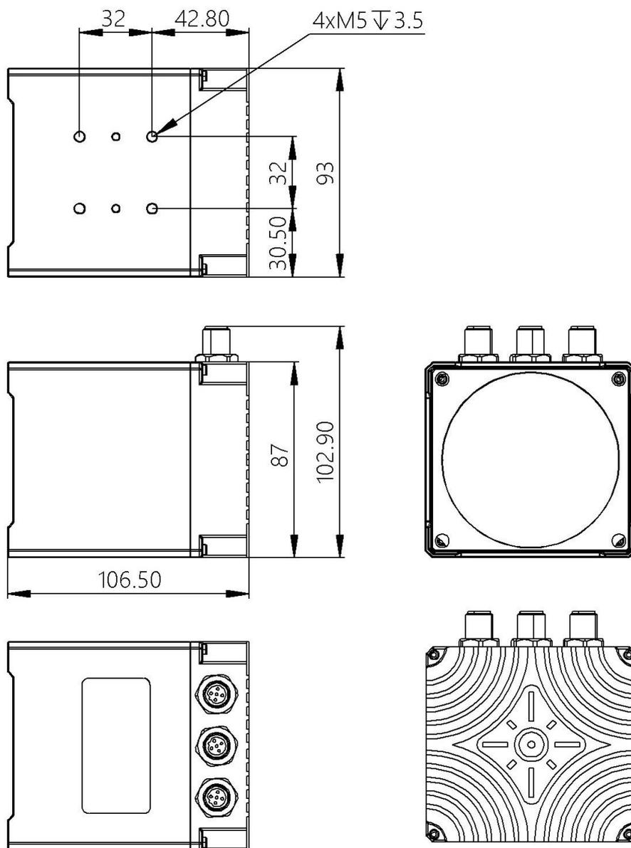
图 3.1: 传感器尺寸图 (单位: mm)
