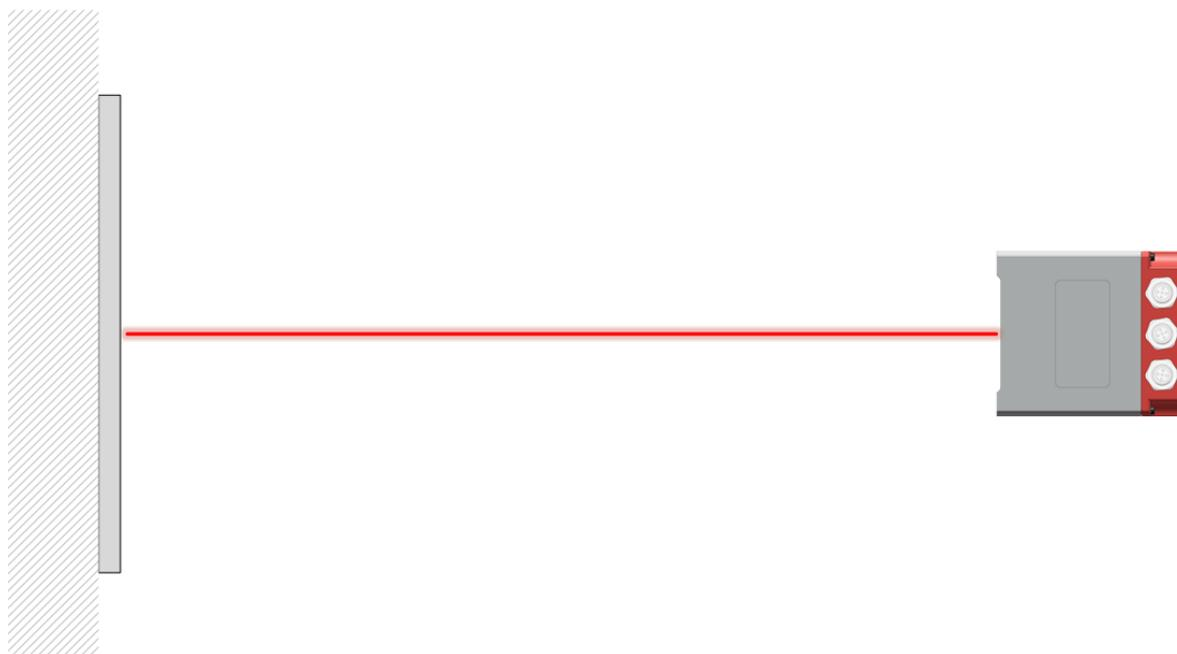
图 4.3: 激光测距传感器及反射板安装示意
